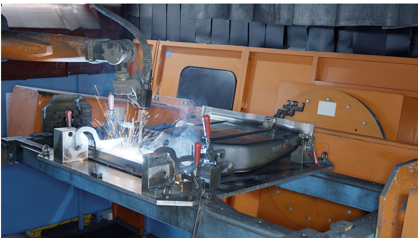
Bild 1: CLOOS-Roboter schweißen die Bauteile zunächst.
