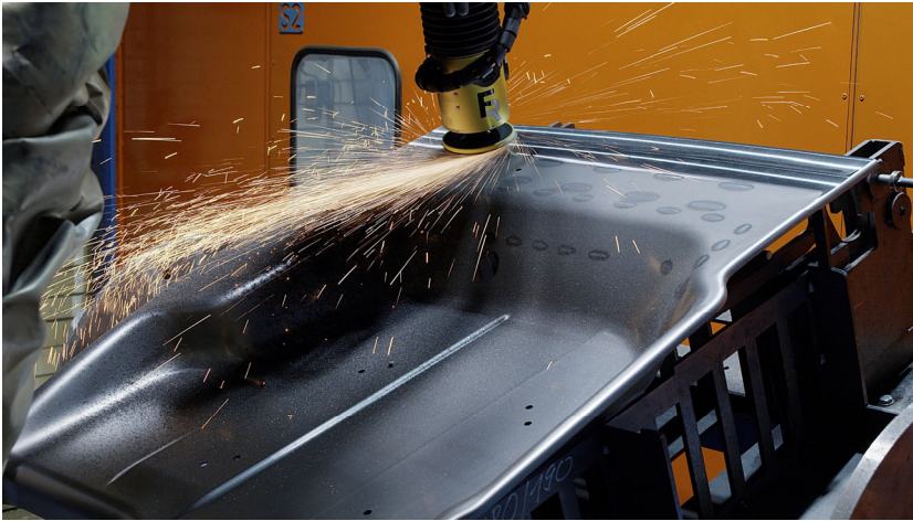
Bild 2: Anschließend folgt der automatische Schleifprozess.
