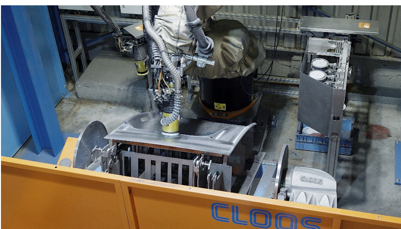
Bild 4: Den Feinschliff übernimmt der Roboter ebenfalls.
