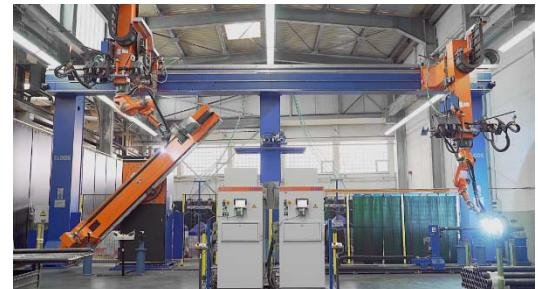
In den großen automatisierten Roboter-Schweißanlagen der Carl Cloos Schweißtechnik GmbH kommen mayr®-Bremsen zum Einsatz. Die ROBA®-topstop®-Bremsen dienen als zweite Bremse im Sicherheitssystem.
