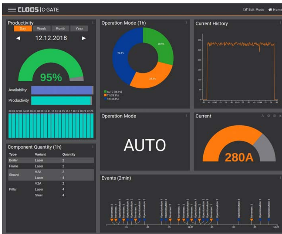
Bild 1: Das Dashboard des neuen C-Gate bietet vielfältige Funktionen zur Visualisierung von Schweiß- und Roboterdaten.
