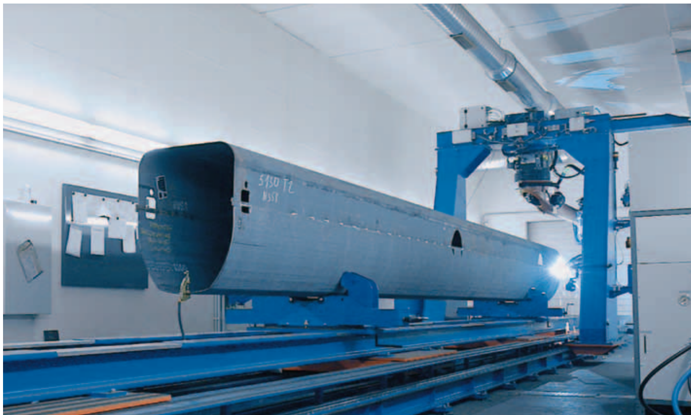
Rameno mobilního jeřábu se skládá ze základní části a až šesti teleskopických částí, z nichž každá je dlouhá až 14 metrů. Spodní poloviční skořepina je ze silnějšího plechu než horní. Jednotlivé části ramena se přitom vyrábějí z vysokopevnostních jemnozrnných ocelí o tloušťce 4 až 15 mm.
