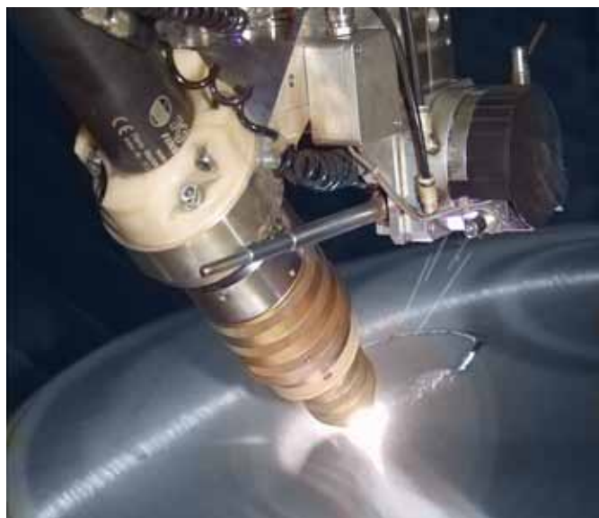
Dotyková snímací hlava na rameni plazmového hořáku nejprve proměří torisférická, kónická, eliptická nebo polokulová dna a na stranách vyznačí místa, kde bude dno později přesně umístěno a přivařeno k plášti nádrže.
