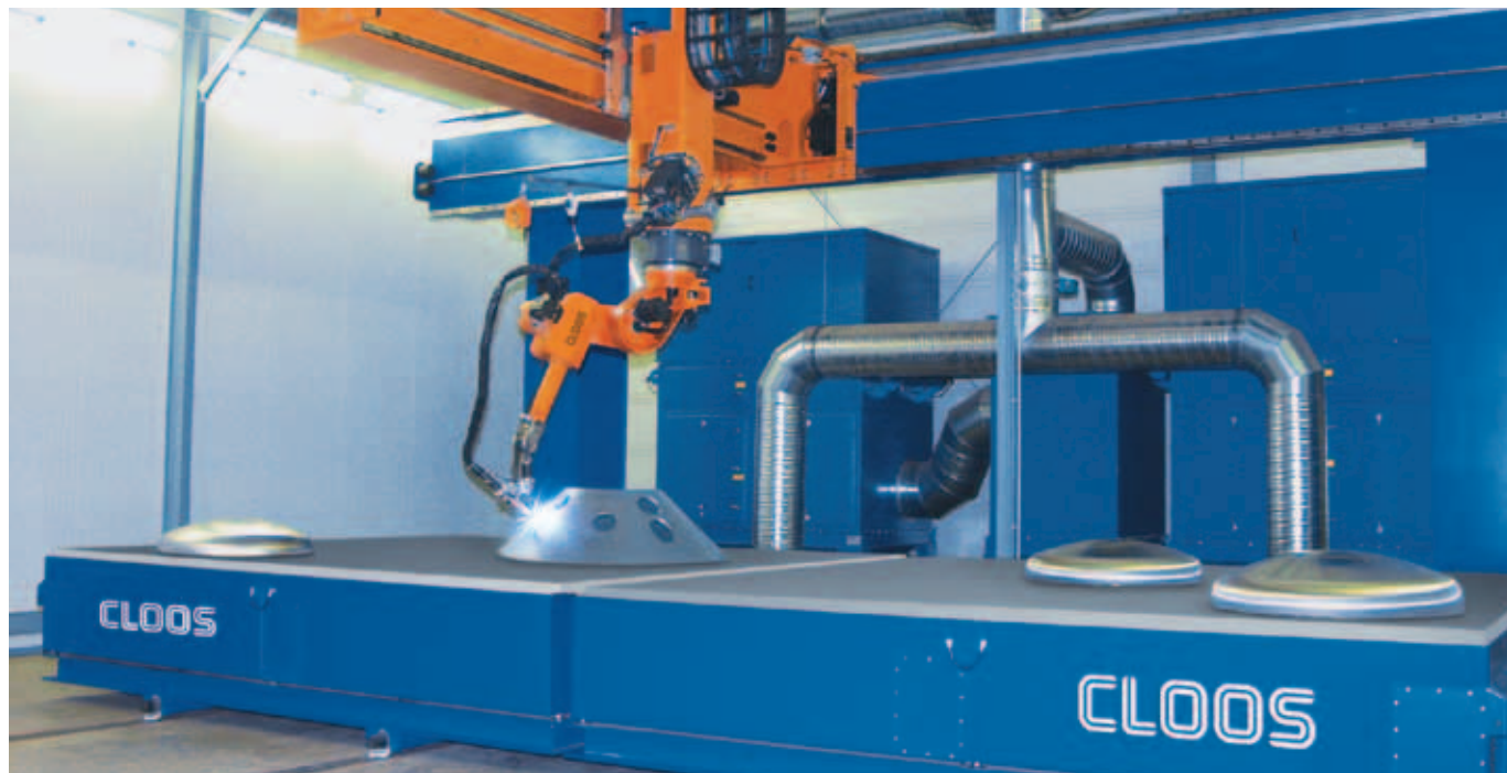
Robotické zařízení se skládá z 8 metrů dlouhého a 3 metry širokého portálu s výškou zdvihu 1 metr. Robot typu QRC 350 zde vyřezává otvory a kontury do kónického dna nerezové nádrže.
