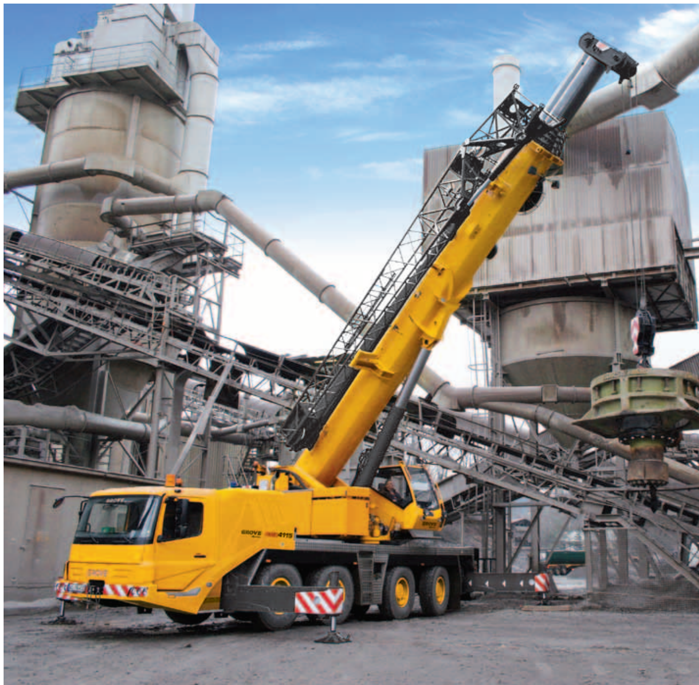
Autojeřáb Grove GMK4115 s maximálním zatížením 100 t, délkou ramena 11,3 m a úhlem ramena od -1,5^{\circ} až do +82^{\circ} .
