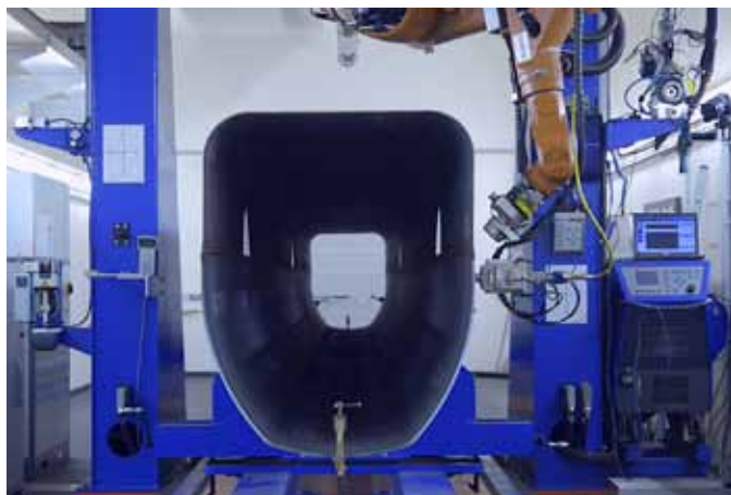
Automatické značení pozic pro umístění otvorů probíhá nyní ve srovnání s ručním řezáním o 80 procent rychleji.
