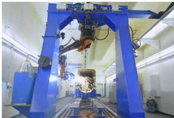
Následné vyřezání každého otvoru trvalo dříve 15 minut, nyní laser zvládne za stejnou dobu vyřezat 30 otvorů.
